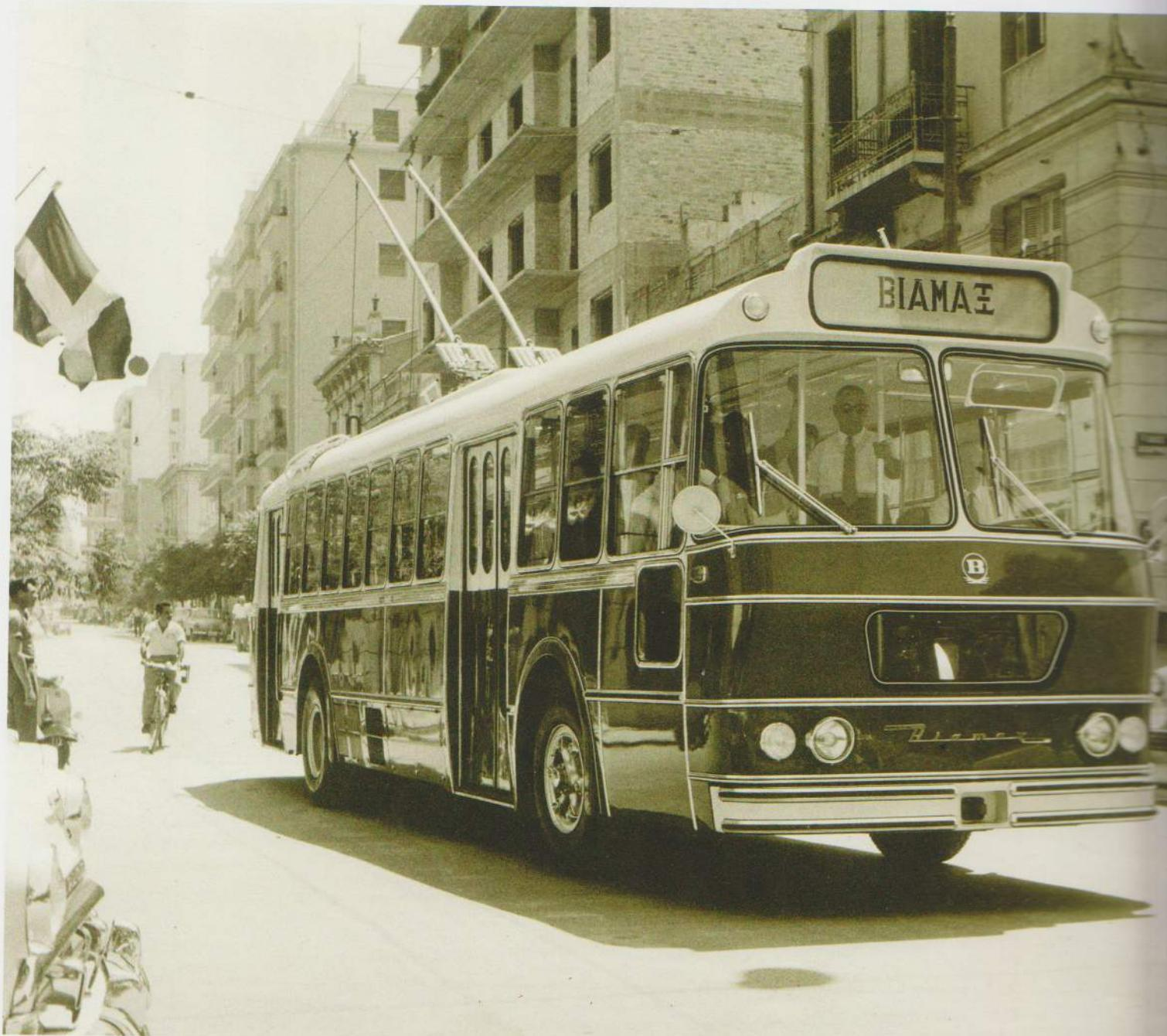
*Δοκιμαστική κυκλοφορία των πρώτων τρόλλευ ελληνικής κατασκευής, Biamax πάνω σε πλαίσιο Lancia και ηλεκτρικό εξοπλισμό της CGE. Το τρόλλευ αυτό κατασκευάστηκε πιλοτικά, λίγο μετά το τραγικό νανύο των απηματαγωγών «Ηράκλειο» του Δεκέμβριο του 1966, κοντά στη βραχονησίδα Φαλκονέρα. Για το λόγο αυτό οι οδηγοί της HEM τον κόλλησαν το παρασσόντελο «Φαλκονέρα». Η σκέδιαση έγινε από τον Ιωάννη Δρακούλη και η κατασκευή από τον Αντόνιο Ρίζο. Αρχείο Biamax.*
